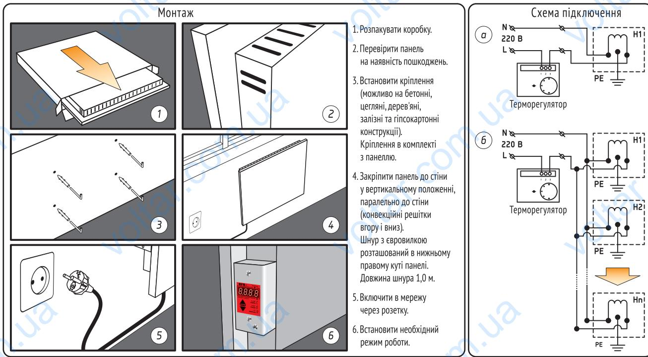
На рис. «а» представлена схема підключення одного обігрівача через терморегулятор. На рис. «б» – схема підключення групи обігрівачів. При монтажі, згідно схеми «б», слід враховувати технічні характеристики терморегулятора і не допускати його перенавантаження.
