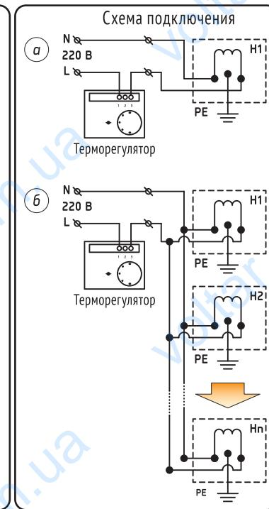
На рисунке «а» представлена схема подключения одного обогревателя через терморегулятор. На рисунке «б» – схема подключения группы обогревателей. При монтаже, согласно схемы «б», следует учитывать технические характеристики терморегулятора, чтобы не превышать мощность, указанную в его характеристике.
