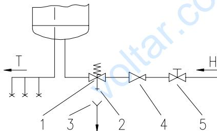
Схема подключения водонагревателя к системе водоснабжения
