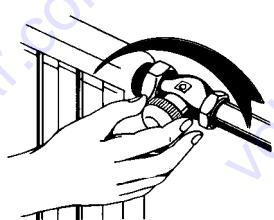
1. Снять защитный колпачок.
