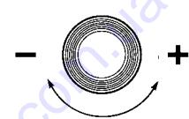
Клапан закрывается поворотом по часовой стрелке и открывается – поворотом против часовой стрелки.
