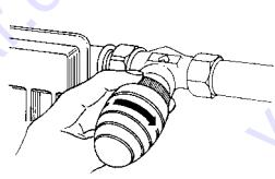
3. Умеренно затянуть вручную накидную гайку (у привода „D“ с помощью рожкового ключа).
