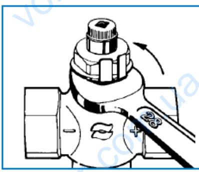
Рис. 4. Используя гаечный ключ 28 мм, вывинтить верхнюю часть клапана, вынуть терmostатический элемент в комплекте с пружиной и диском. Промыть водой и вернуть в исходное положение. Собрать клапан.
