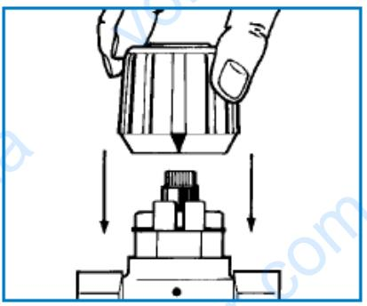
Рис. 3. Вновь надеть маховик, так чтобы указатель V совпал с выпуклой риской на корпусе клапана. В этой позиции маховик зафиксирован.
