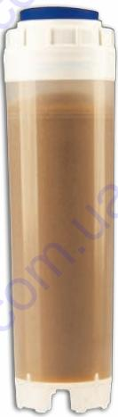
Картридж с ионообменной смолой предназначен для смягчения воды. Во время процесса фильтрации удаляются среди прочего ионы кальция и магния, соли которых вызывают жёсткость воды. После фильтрации получаем мягкую воду.
