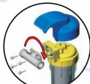
Для изменения направления течения воды через фильтр достаточно повернуть присоединитель головки фильтра на 180°
