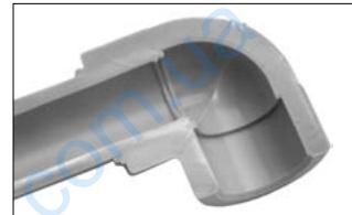
Соединение полипропиленовых деталей производится при помощи полифузной, электромуфтовой или стыковой сварки. При сварке возникает гомогенный шов высокого качества. При сварке необходимо точно соблюдать правила монтажа и использовать специальные качественные инструменты. Детали системы Ekoplastik не рекомендуется сваривать с деталями других производителей.
