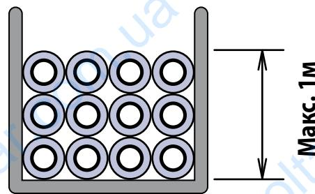
Полипропиленовые трубы следует укладывать на стеллажи или иные поверхности всей плоскостью (необходимо избегать прогиба труб). Пластиковые фитинги хранятся в мешках, коробках, контейнерах, ящиках и т.п. При хранении труб в пластиковых рукавах и фасонных изделий в пластиковых мешках высота штабеля не должна превышать 1 метра. Различные виды труб и фитингов необходимо хранить отдельно друг от друга. Первыми нужно вывозить со склада детали, хранившиеся наиболее долго.
