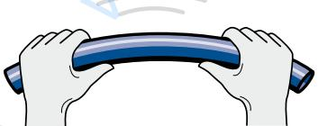
Минимальная температура для сгибания полипропиленовых труб без нагрева +15 °C (монтаж теплого пола). Минимальный радиус изгиба труб диаметром 16-32 мм равен 8-ми диаметрам изгибающей трубы.
