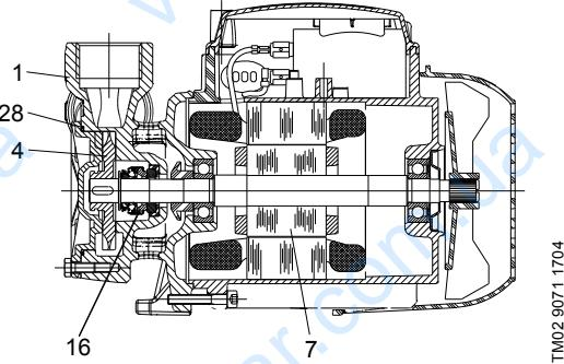
Рис. 91. Разрез насоса PF
