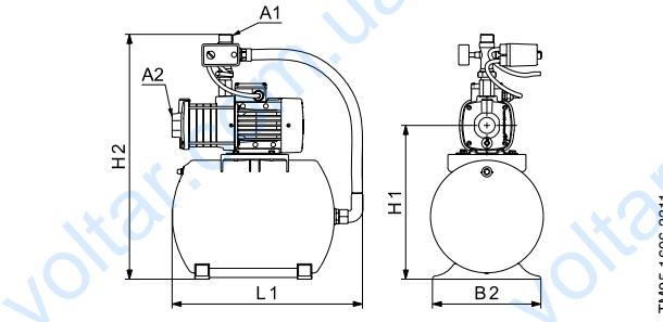
Рис. 59. Габаритные и присоединительные размеры насосов СМВ
