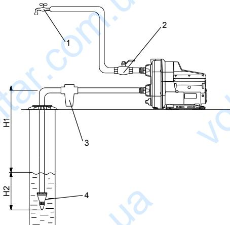
Рис. 56. Подача воды из колодца / скважины
