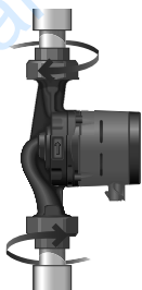
Рис. 3 Монтаж насоса ALPHA3
