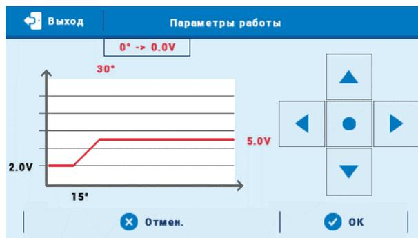
В соответствии с этим коэффициентом преобразования напряжение должно увеличиваться на 0,2V на каждый 1°C заданной температуры ( $3:15 = 0,2$ ).
