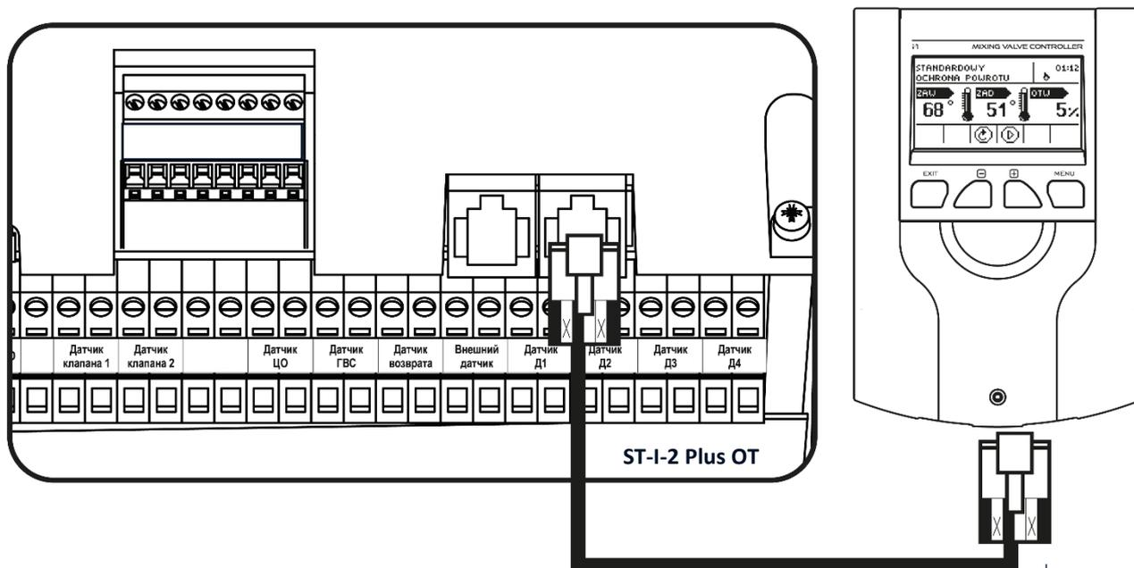
Примерное соединение дополнительного клапана с главным контроллером ST-I-2 Plus OT
