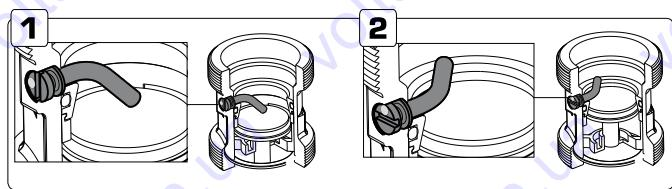
По завершении заполнения и вентилирования заверните винт на запорном клапане в нормальное рабочее положение (см. Рис. 2) и установите ручку управления циркуляционным насосом в рекомендуемое положение. См. главу 5.
