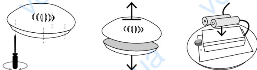
Наконец положите друг на друга нижнюю и верхнюю части беспроводного датчика температуры и снова свинтите их. Если обнаружите, что датчик температуры по какой-либо причине не имеет связи с центральным устройством, синхронизируйте эти два устройства еще раз с помощью шагов, описанных в пункте 2.2.
