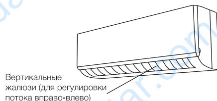
Направление воздушного потока по горизонтали можно регулировать с помощью пульта ДУ. Нажмите кнопку SWING2 на пульте ДУ и установите либо режим автоматического покачивания жалюзи, либо одно из фиксированных положений на ваше усмотрение. Для фиксации выбранного положения, нажмите кнопку повторно.
