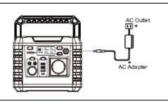
Laden mittels AC-Ladegerät
