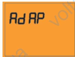
Отпускание кнопки **SET** начнет процесс адаптации. Если во время адаптации, запущенной вручную, произойдет ошибка, нажатие любой кнопки или 8 секунд без нажатия кнопок вернет PH60 в **НОРМАЛЬНЫЙ** режим.
