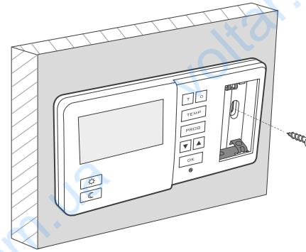
**Внимание:** Если стена деревянная, нет необходимости в использовании дюбелей. Следует высверлить отверстия диаметром 2,7 мм вместо 6 мм и шурупы ввинтить непосредственно в дерево.
