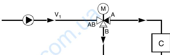
Рис. 1: 3-х ходовой разделительный клапан
