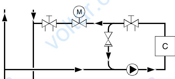
Рис. 10: Контур предварительного нагрева для случаев, когда существует опасность замерзания
