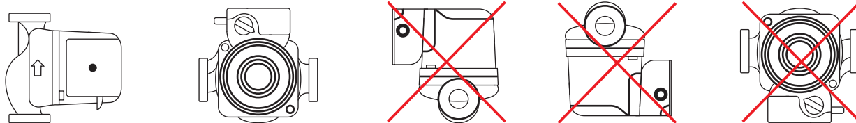
Варианты установки циркуляционных электронасосов с «мокрым» ротором
