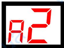
Эта функция служит для установки гистерезиса работы насоса. Это разница между температурой входа в цикл **работы** и температурой возврата в цикл **поддержки** (например: когда *заданная температура* равняется 60°C, а гистерезис составляет 3°C, переход в цикл **работы** произойдет после достижения температуры 60°C, а возврат к циклу **поддержки** произойдет после понижения температуры до 57°C).
