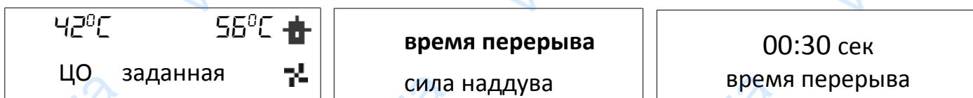
Время перерыва используется для установления перерыва работы питателя. Перерыв должен быть настроен в зависимости от типа топлива. Неправильный подбор рабочего времени и перерыва может привести к неправильной работе котла, то есть топливо может быть не до конца сожжено, а котел может не достичь заданной температуры. Правильный подбор подходящего времени работы и перерыва позволяет работать котлу должным образом.
