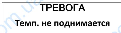
Сигнал тревоги можно выключить нажав клавишу **ВЫХОД**. Контроллер возвращается к последнему рабочему режиму.
