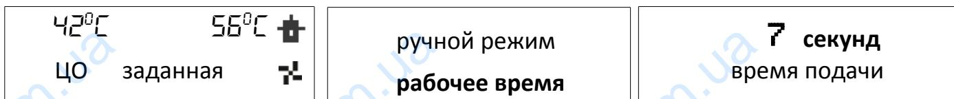
\*Эта функция является активной только для котлов со шнековым питателем. С помощью этой опции можно установить рабочее время подачи топлива, которое зависит от применяемого топлива и типа котла.
