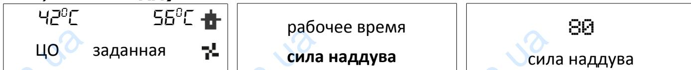
Эта функция управляет скоростью вращения вентилятора. Предел регулировки - 1-100%.
