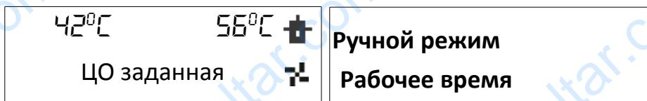
Для удобства пользователя регулятор оборудован модулем ручного режима. В этой функции каждый элемент включается и выключается независимо от остальных.
