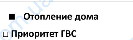
В этой опции регулятор управляет отоплением дома. Насос ЦО начинает работать выше температуры, при которой включаются насосы ( заводская установка это 40 ° С — смотреть главу II). Ниже этой температуры (учитывая установленный гистерезис ЦО) насос перестает работать.
