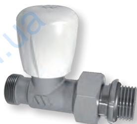
Никелированный регулирующий клапан с возможностью термостатического управления. Прямое исполнение. Для соединения с трубами из меди или пластика диаметра 1/2"НР. Штуцер с кольцевым уплотнением для подключения к радиатору. Пластиковый маховик, подвижный шток. Совместим с термостатическими головками серии 148, 148А, радиаторным радиотермостатом BT-TH02-RF и сервоприводами 22CX, 26LC
