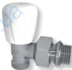
Никелированный регулирующий клапан с возможностью термостатического управления. Угловое исполнение. Для соединения с трубами из меди или пластика диаметра 1/2"НР. Штуцер с кольцевым уплотнением для подключения к радиатору. Пластиковый маховик, подвижный шток. Совместим с термостатическими головками серии 148, 148А, радиаторным радиотермостатом BT-TH02-RF и сервоприводами 22CX, 26LC.
