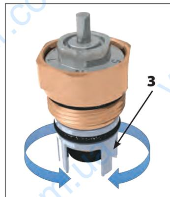
Клапаны снабжены специальным устройством (3) для регулирования гидравлических потерь. Оно позволяет не только перекрывать контур, как стандартные клапаны, но и осуществлять балансировку, обычно осуществляемую запорными клапанами, ускоряя тем самым процесс балансировки.
