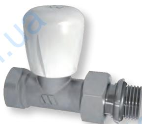
Никелированный регулирующий клапан с возможностью термостатического управления. Прямое исполнение. Для соединения с трубами из стали. Штуцер с кольцевым уплотнением для подключения к радиатору. Пластиковый маховик, подвижный шток. Совместим с термостатическими головками серии 148, 148А, радиаторным радиотермостатом BT-TH02-RF и сервоприводами 22CX, 26LC.
