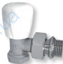
Никелированный регулирующий клапан с возможностью термостатического управления. Угловое исполнение. Для соединения с трубами из стали. Штуцер с кольцевым уплотнением для подключения к радиатору. Пластиковый маховик, с подвижным штоком. Совместим с термостатическими головками серии 148, 148А, радиаторным радиотермостатом BT-TH02-RF и сервоприводами 22CX, 26LC.
