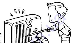
Не вставляйте посторонние предметы в воздуховыпускное отверстие комнатных и наружный блоки кондиционера. В них с большой скоростью работают вентиляторы, прикасаться к которым небезопасно.
