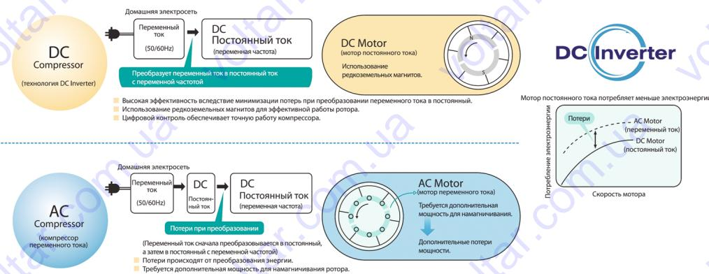
Компрессор с инвертором постоянного тока позволяет увеличить эффективность работы кондиционера, снизить потребление энергии и сэкономить эксплуатационные затраты - за счёт более высокой надёжности в том числе. Для покупателя инверторная сплит-система экономнее (в среднегодовом цикле - до 40%)! и надёжнее, чем кондиционеры с постоянной мощностью компрессора за счёт меньших нагрузок на исполнительные компоненты и компрессор - нет «скачкообразных» циклов включения.
