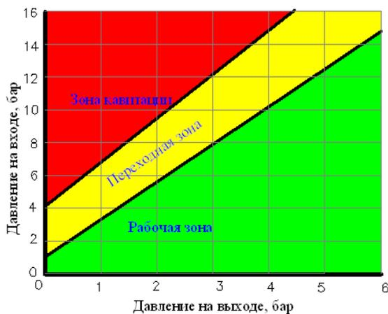
4.3. **Граничное условие 2:** соотношение давления на входе и на выходе регулятора должно быть таким, чтобы попадать в рабочую или переходную зону графика кавитации.
