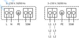
обобщенная сигнализация неисправности (нормальнозамкнутый контакт по VDI 3814, предельно допустимая нагрузка 1 А, 250 В ~)
