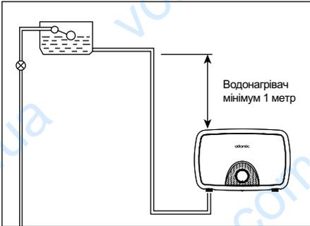
**ПРИЄДНАННЯ ВОДОНАГРІВАЧА У САМОПЛИВНІЙ СИСТЕМІ**
