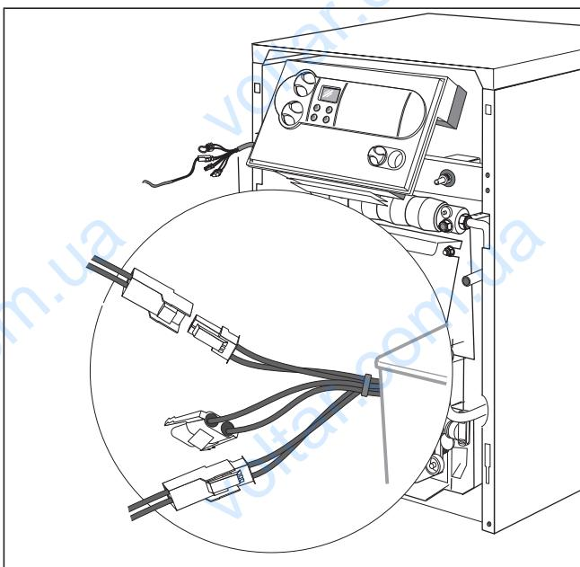
Рис. 4.6 Подключение датчиков
