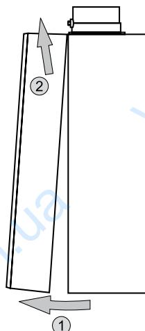
Нажать на два крепежных крючка внизу слева и справа и потянуть обшивку вперед. Отцепить переднюю обшивку по направлению вверх и снять ее.
