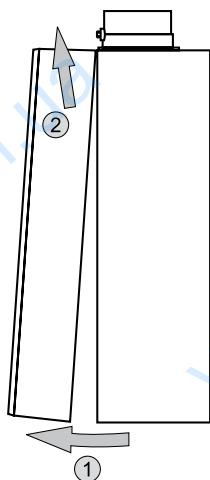
Нажать на два крепежных крючка внизу слева и справа и потянуть обшивку вперед. Отцепить переднюю обшивку по направлению вверх и снять ее.
