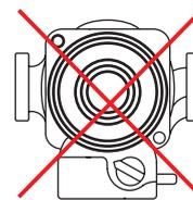
Варианты установки циркуляционных электронасосов с «мокрым» ротором
