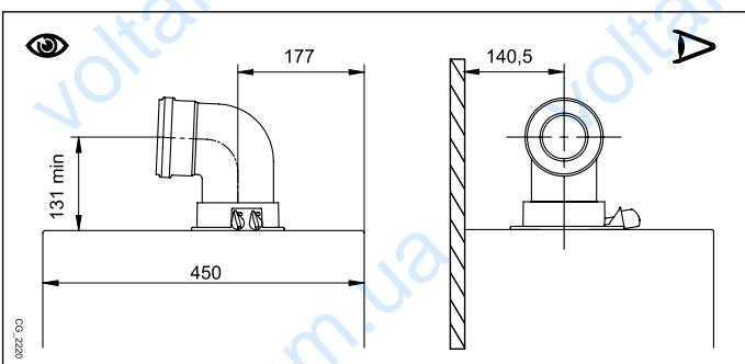
• 90° отвод сокращает возможную полную длину трубы на 1 метр.
