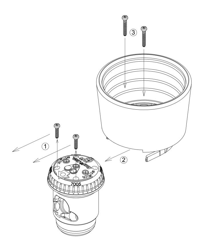
SOD CUP INSTALLATION USING TORX SCREWS
