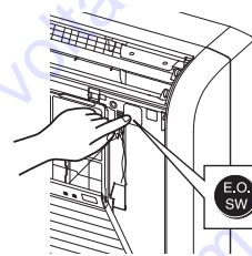
Переключатель аварийного управления (E.O. SW)
