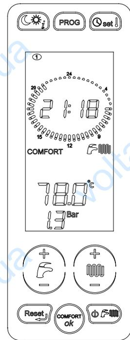
1- При подключенном датчике температуры наружного воздуха, с помощью кнопок «+» и «-» отопление (E на рис. 1) возможно установить фиктивную комнатную температуру. По окончании установки символ «комнатной температуры» будет мигать еще в продолжении 3 с, даже если при этом есть запрос в контуре ГВС.
