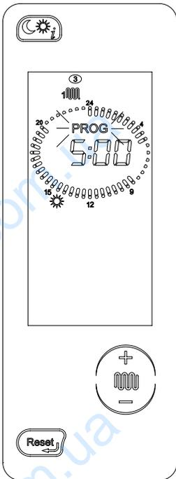
**3-** Регулируемый временной интервал отображается мигающим сектором на циферблате. Данная информация дублируется также в цифровом виде по центру циферблата. Нажимая кнопку «солнце/луна», мы можем выбрать для данного интервала «дневной» или «ночной» уровень температуры (при этом на дисплее отобразится пиктограмма «солнце» или «луна» соответственно). Переход между временными интервалами осуществляется посредством кнопок «+» и «-» отопление. Кнопками «+» и «-» отопление можно устанавливать время.
