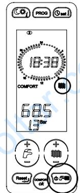
6. Для регулировки температуры ГВС нажать кнопки «+» и «-» ГВС (D на рис. 1). Регулировать впоследствии температуру соответственно с собственными потребностями.
