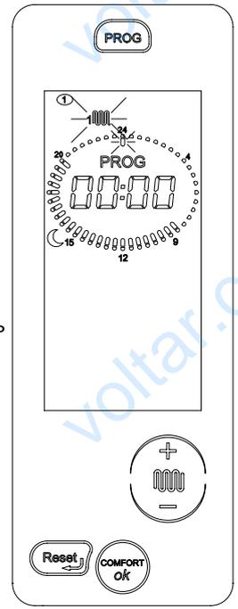
Для того чтобы выйти из режима программирования необходимо нажать кнопку «reset» два раза. Порядок изменения программ зоны отопления 2 и бойлера, аналогичен таковому для зоны отопления 1. Нажимая кнопку «prog» мы можем изменить 4 программы: «ручная», зона отопления 1, зона отопления 2, бойлер.
