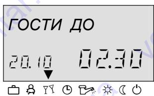
Данная программа предлагает возможность одноразового мгновенного нагрева всех контуров отопления вплоть до заранее установленного времени, и позволяет частично или полностью пропустить последующий или уже действующий ограниченный цикл. По прошествии установленного времени контуры отопления автоматически вернутся к рабочему режиму, действовавшему до настройки режима «Гости». Такие краткосрочные программы, как *Отсутствие* или *Отпуск* в данный режим не входят.
