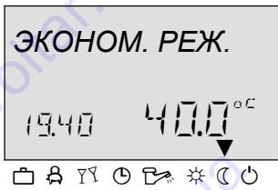
Данный режим предлагает постоянное ограниченное отопление в соответствии с установленной пониженной температурой в комнате при соответствующем режиме ECO (режим отключенной защиты от замерзания) или ABS (режим ограничения), настроенном для контура отопления, согласно нижнему температурному пределу соответствующего контура отопления.
