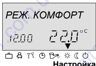
Данная программа предлагает непрерывное отопление в соответствии с установленной дневной комнатной температурой. Нагрев ГВС действует непрерывно согласно настроенной величине для обогрева ГВС.
