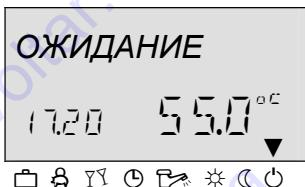
В данном режиме вся система находится в отключенном состоянии, активной остается лишь защита от замерзания (все функции защиты от замерзания остаются активными). Нагрев горячей воды остановлен, действует исключительно защита от замерзания. При температуре бака ниже 5°C вода нагревается до 8 °C.
