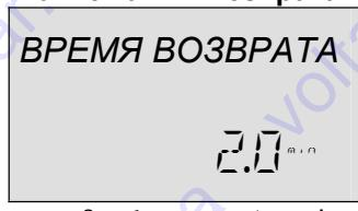
При удерживании кнопки «Информация» в нажатом состоянии в течение ок. 3 с. Появится параметр ВРЕМЯ ВОЗВРАТА.
